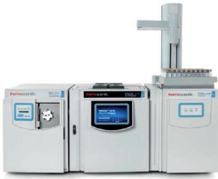
Система газового хроматографа Trace 1610 з мас-детектором ISQ 7610 та парофазним автоінжектором TriPlus 500
