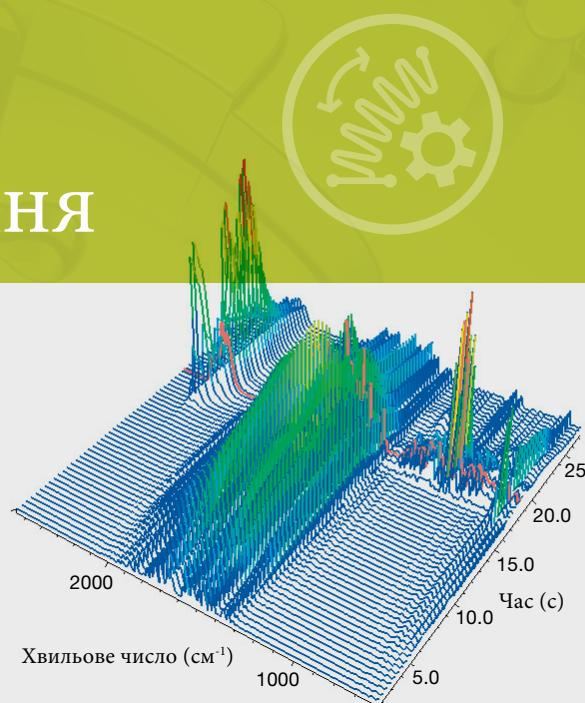
Програмне забезпечення серії OMNIC, унікальний пакет аналізу Mercury TGA та 3D-дисплей дозволяють швидко та ефективно отримувати корисну інформацію з ТГА-ІЧ (термогравіметричний інфрачервоний аналіз) та інших експериментів, що ґрунтуються на вимірюванні часу.
