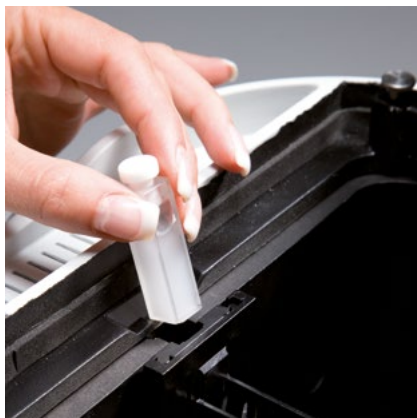
Специальная позиция для размещения мутных сильно рассеивающих образцов
