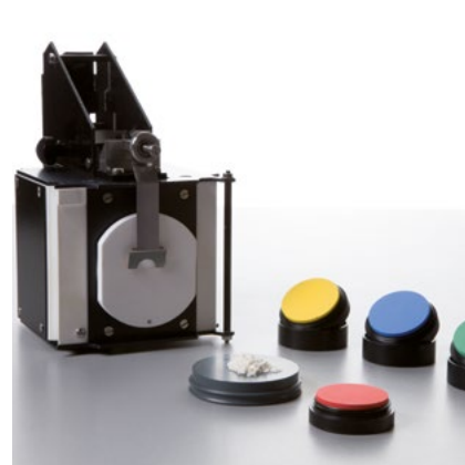
Приставка для определения коэффициента диффузного отражения с интегрированной сферой
